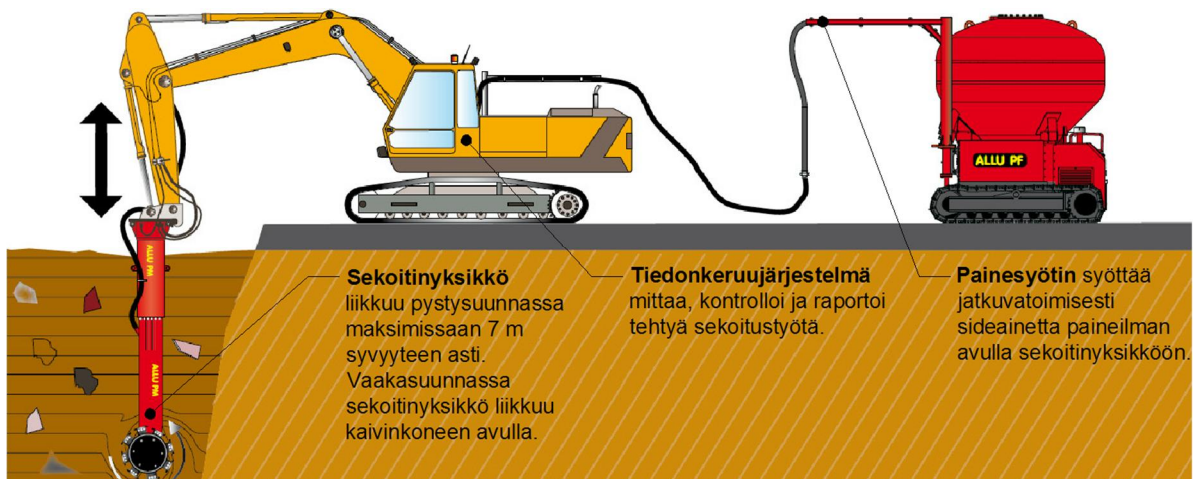
Kuva 1. Massastabilointilaitteisto ja menetelmän yleisperiaate. Pehmeä maa-aines lujitetaan (parannetaan rakentamiskelpoiseksi) syöttämällä sideainetta säiliöstä painesyöttimen avulla kaivinkoneen puomin päässä olevaan sekoitinkärkeen ja sitä kautta maa-ainekseen. (Forsman et al. 2014)
